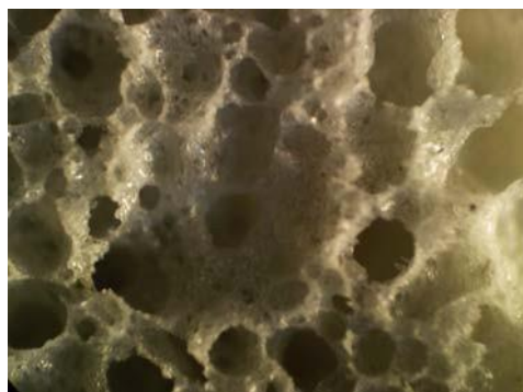
Рис. 2. Микрофотография скола пеностекла
