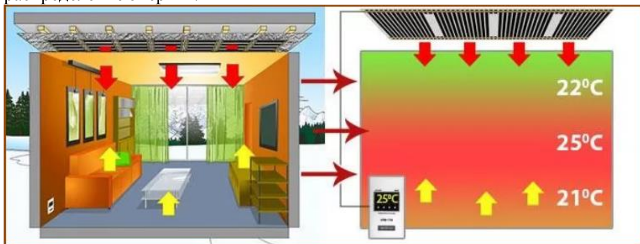
Рис. 1. Принцип отопления дома инфракрасными обогревателями.
